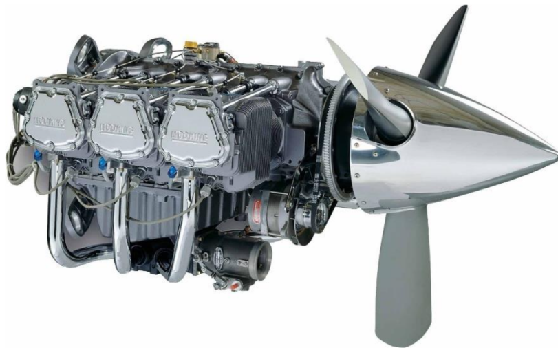
Figura 1.7. Il gruppo motoelica: il motore alternativo, alloggiato nella gondola dietro l'elica, trasmette la potenza all'asse attraverso l'albero. L'elica converte quella potenza in spinta. Sono indicate le due grandezze protagoniste di questa sezione: la potenza all'asse \Pi (all'uscita del motore) e la potenza disponibile \Pi_d (a valle dell'elica).
