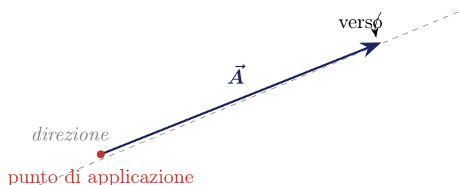
Figura 2: Rappresentazione grafica di un vettore: direzione, verso, modulo (lunghezza) e punto di applicazione.
