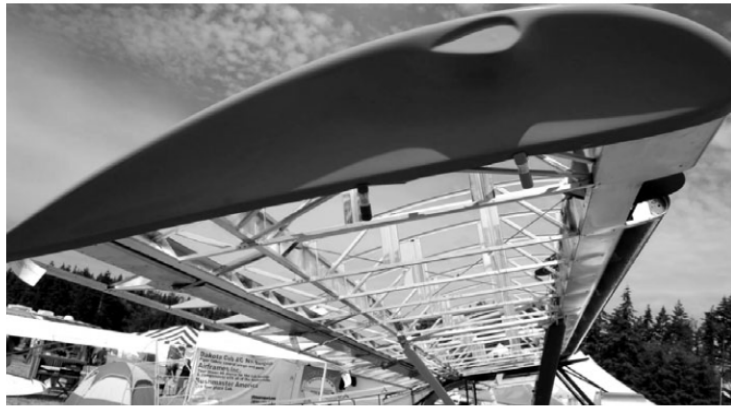
Figura 59 – Struttura classica “a centine e longheroni”. Le centine, reticoli sagomati come il profilo, danno forma all’ala e raccolgono il carico del rivestimento; lo trasmettono ai longheroni (anteriore e posteriore), che lo portano fino alla radice. Il rivestimento (tela, poi lamiera) non sopporta i carichi di flessione.
