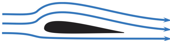
Figura 2 – Rappresentazione comune (e scorretta) del flusso: l'aria arriva orizzontale e riparte orizzontale. Non vi è alcuna deviazione netta verso il basso e dunque, per le leggi di Newton, nessuna portanza.
