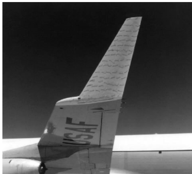
Figura 30 – Una winglet: l'estremità alare rivolta verso l'alto. Bloccando il travaso d'aria dal ventre al dorso attorno alla punta, consente all'ala di portare carico fino all'estremità, aumentando l'apertura efficace e quindi il rendimento senza accrescere l'apertura reale.
