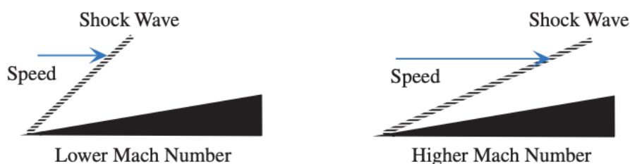
Figura 48 – Al crescere del numero di Mach l'angolo dell'onda d'urto obliqua diminuisce (l'onda si inclina sempre più all'indietro). Sebbene l'urto diventi più intenso, l'angolo minore fa sì che la resistenza d'onda cresca lentamente con il Mach.
