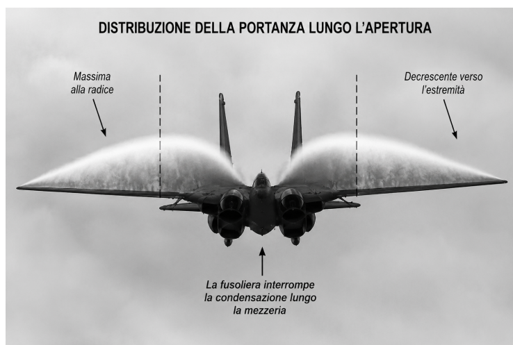
Figura 14 – La condensazione del vapore acqueo sul dorso dell’ala, durante una manovra ad alto fattore di carico, rende visibile la distribuzione della portanza lungo l’apertura: massima alla radice, decrescente verso l’estremità (la fusoliera interrompe la condensazione lungo la mezzeria).
