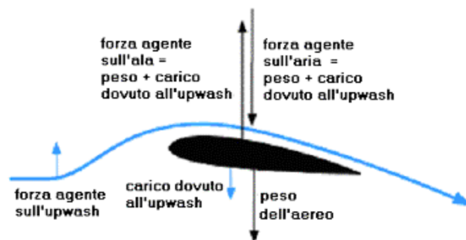
Figura 16 – Ala lontana dal suolo. La risalita dell'aria al bordo d'attacco ( upwash ) genera sull'ala un carico aggiuntivo diretto verso il basso, che si somma al peso e accresce la potenza indotta necessaria.
