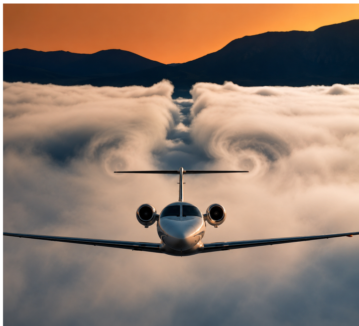
Figura 5 – Effetto del flusso deviato verso il basso su un banco di nebbia sorvolato a bassa quota: il velivolo è passato sopra la nebbia, non dentro, eppure l'aria discendente scava un solco ben visibile, ai cui margini si avvolgono i vortici d'estremità.
