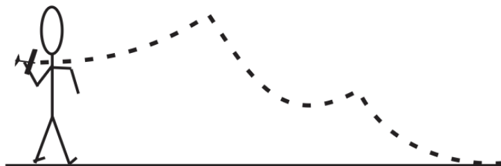
Figura 35 – Il moto fugoide: una lenta successione di salite (con rallentamento) e discese (con accelerazione) a incidenza quasi costante, scambio continuo fra energia cinetica e potenziale. Il periodo, dell’ordine dei minuti, lo rende del tutto gestibile.
