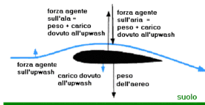
Figura 17 – Ala in prossimità del suolo. La vicinanza del terreno ostacola la circolazione sotto l'ala e riduce l' upwash : il carico addizionale diminuisce, l'angolo d'incidenza può essere ridotto e la potenza indotta cala. Il rendimento dell'ala aumenta.
