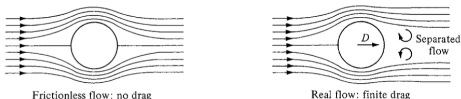
Figura 9. Flusso ideale attorno a una sfera: la perfetta simmetria monte–valle implica resistenza nulla (paradosso di d'Alembert).
