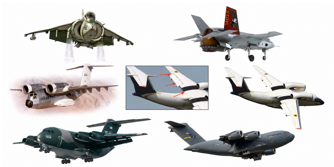
Figura 6.1. I sistemi attivi: vectored thrust (Sea Harrier, X-35); Upper Surface Blowing (YC-14, An-72, con superfici dei flap in acciaio per alte temperature); Externally Blown Flaps (YC-15, C-17).
