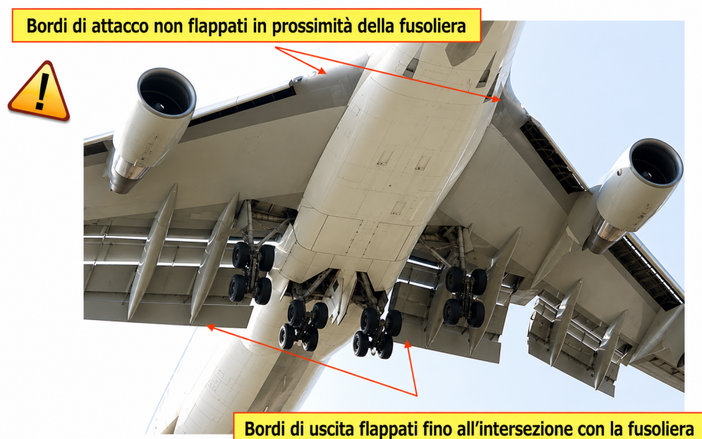
Figura 4.1. Quadrigetto visto dal basso in configurazione di atterraggio: bordi di attacco non flappati alla radice, bordi di uscita flappati fino alla fusoliera.
