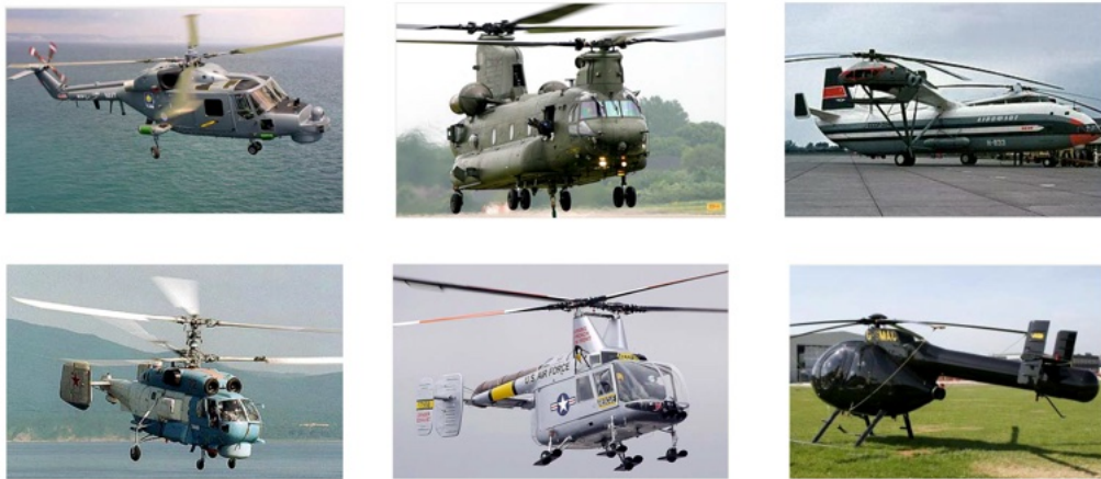
Figura 2. Principali configurazioni degli elicotteri: rotore principale con rotore di coda, tandem, coassiale, affiancata, intersecante e NOTAR.
