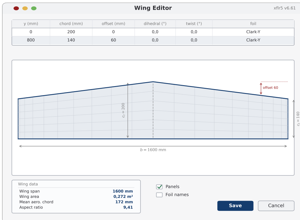
Figura 11: L'editor dell'ala con la geometria di riferimento: apertura 1,6 m, corda di radice 0,2 m, corda d'estremità 0,14 m ( \lambda = 0,7 ), offset di 0,06 m per allineare il bordo d'uscita.
