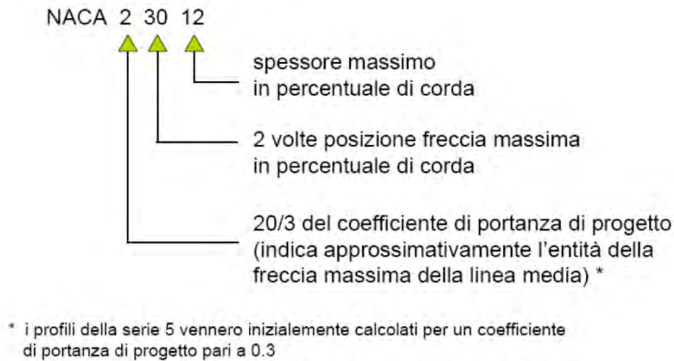
Figura 16. Lettura della sigla NACA a cinque cifre sull'esempio del NACA 23012: coefficiente di portanza di progetto, posizione dell'inarcamento e spessore massimo.
