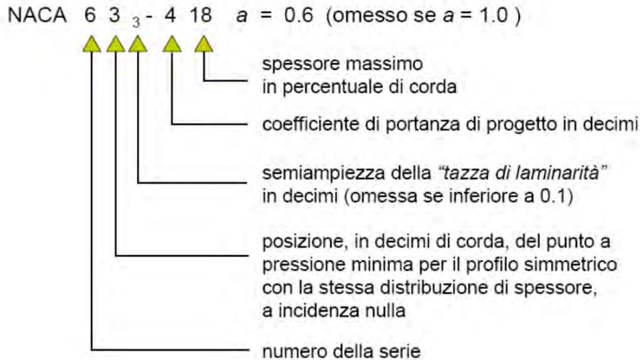
Figura 17. Lettura delle sigle dei profili laminari NACA: serie 1 e serie 6, con il significato di ciascuna cifra.
