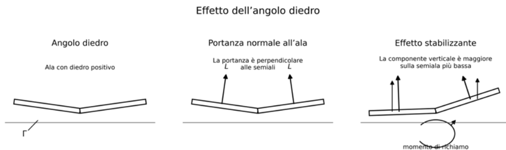
Figura 26. Effetto stabilizzante del diedro positivo: lo scivolo d'ala incrementa la portanza sulla semiala bassa, generando un momento di rollio che riporta il velivolo in assetto.
