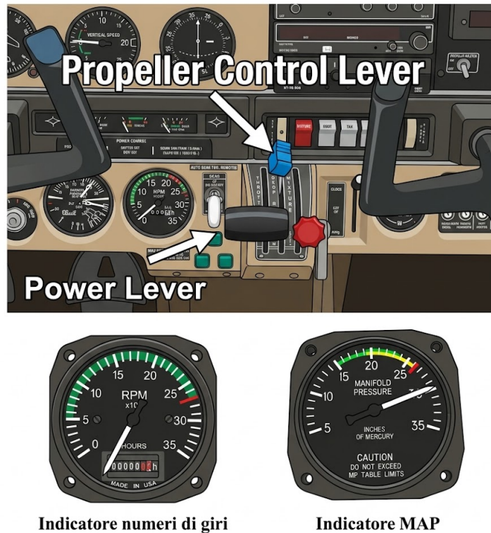
Figura 20. Comandi della motoelica a giri costanti: la Power Lever regola la potenza (letta sul MAP), la Propeller Control Lever seleziona il regime di rotazione che il regolatore mantiene costante variando il passo.
