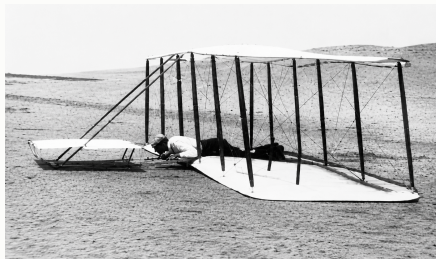
L'aliante n. 2 (1901): configurazione biplana alla Chanute, equilibratore anteriore.
